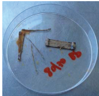
Fibre corrodibili, prova non superata
