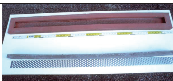
Fig. 4 - Tipico comportamento concavo di una malta che ritira all'aria
