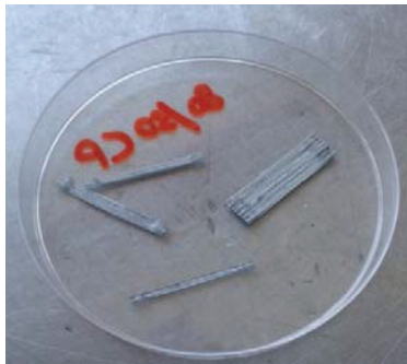
Fibre anticorrosione, prova superata
